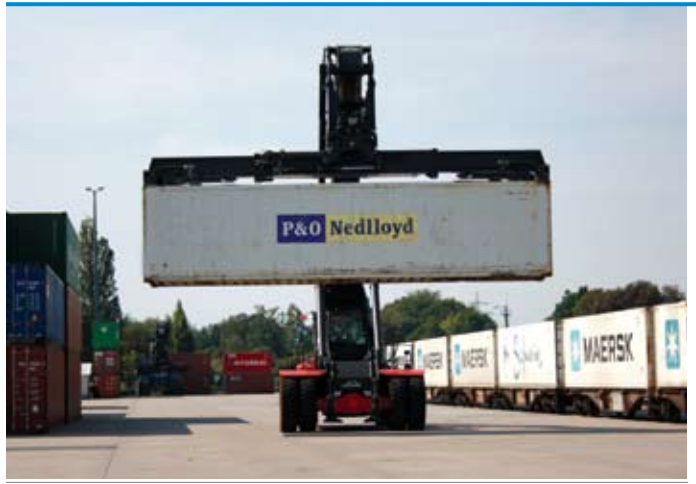
Mit Tragfähigkeiten von 22 bis 45 t bietet der neue Linde-Reachstacker hohe Manövrierfähigkeit und verringerten Lastdruck auf der Kai-Seite | Bilder: Nutsch
