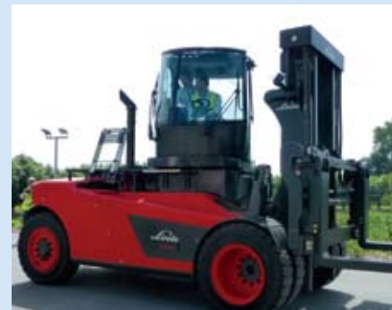
Prototyp eines Schwerstaplers vom Typ 1401 mit um 180 Grad drehbarer Kabine | Bilder: Dünner
